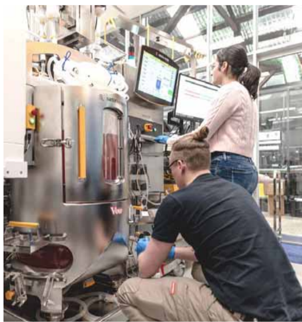
Due addetti al lavoro su un bioreattore per la produzione di carne coltivata della società australiana Vow Meat/ Vow Meat
